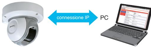
Con PoE abilitato REDSCAN mini genera allarmi utilizzando il codice evento Redwall (REC) che è compatibile con le principali piattaforme NVR, VMS e PSIM tramite un unico cavo
