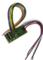
**Concentratore miniaturizzato a 2 ingressi cablati con connessioni pigtail**
