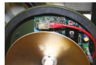
IP-Doorway è un'interfaccia in grado di rendere "IP-ready" tutti i rivelatori digitali CIAS. Mediante IP-Doorway, la barriera o il sensore nel quale viene installato diventa a tutti gli effetti un "rilevatore IP nativo".
