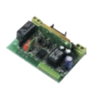
5 AU02910 DRS 4332 Ricevente 2 canali ad innesto per apparecchiature di comando
