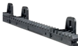
AJ91111 Cremagliera in fibra di nylon con anima in acciaio ed asola di fissaggio modulo 4 (ante max 600 Kg) € 31,00 (prezzo al mt.)
